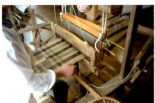
⑧水に濡らしたつぐりを投杼にいれ織っていきます。その後仕上げをして葛布のできあがりです。
